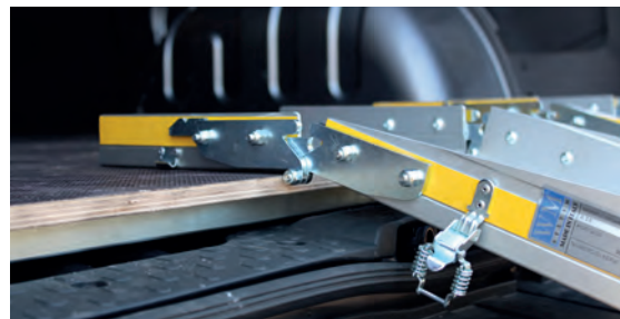
Bočné bezpečnostné hrany proti pádu (5,5 cm)
