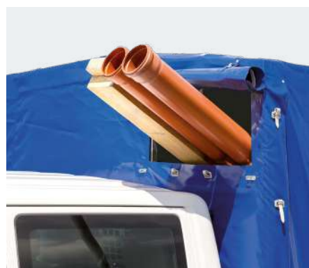
schräger Transport von Langgut mit Ladeluke*
