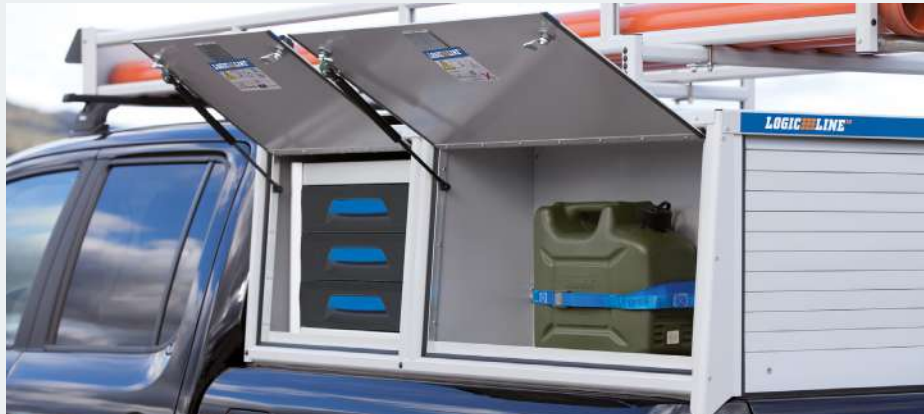
PickUp System: Zurrset (auch für Gefahrgut, Details S. 47)
