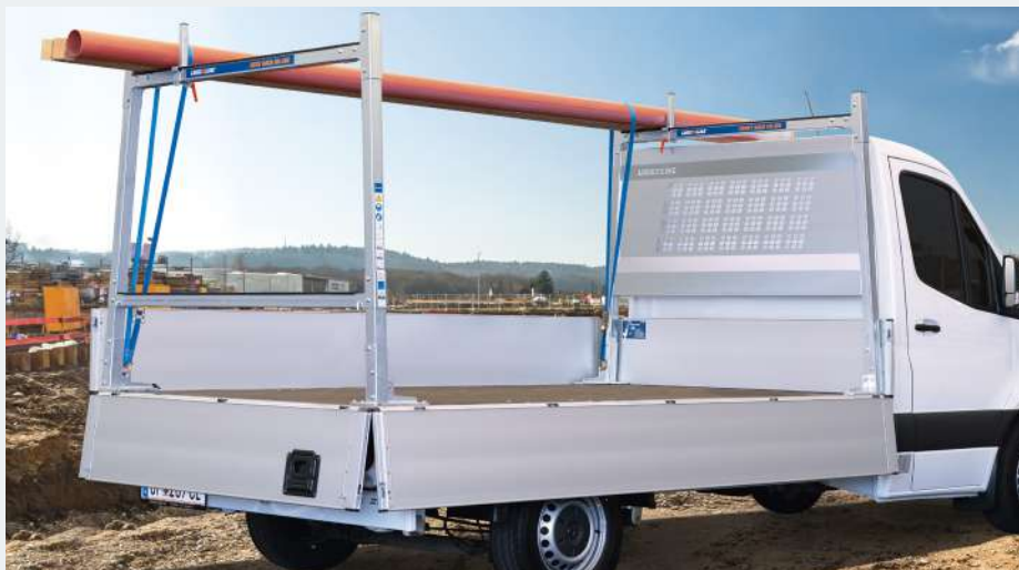
LogicLine FrontRack FR-200 mit Heckscheibenschutz und HeckRack HR-200 mit Lastenstopper
