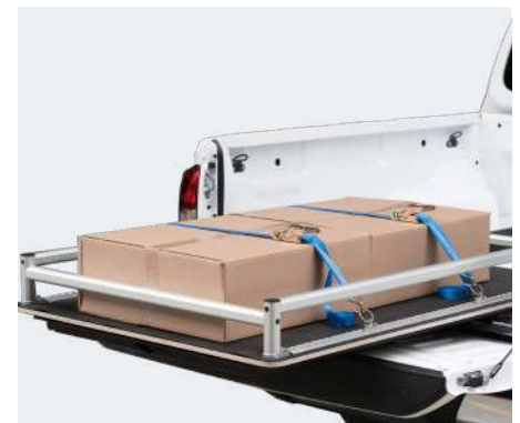
Formschluss durch umlaufende Reling*
