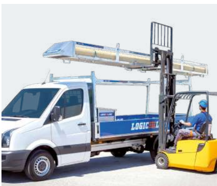
LongRack kann mit Stapler oder Kran auf das PowerRack geladen bzw. auf das Dach gehoben werden
