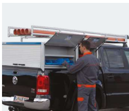
seitliche Klappen mit Gasfeder für integrierte Box und Seitenbox Hardtop*
