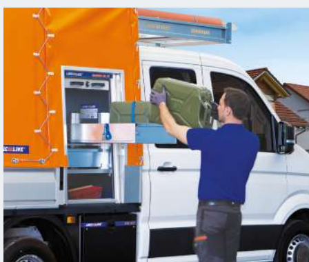
einfaches Be- und Entladen von Kanistern durch Auszugslade für Gefahrguttransport
