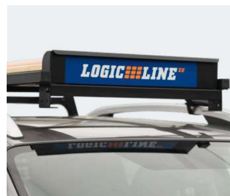
Frontausleger mit integriertem Formschlussblech* (umklappbar) verhindert Rutschen der Ladung
