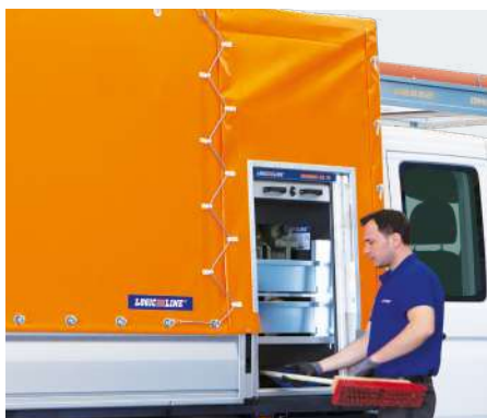
perfekt kombinierbar mit LogicLine Transportboxen; Zick-Zack-Verschluss* für seitliches Aufplanen
