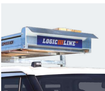
integriertes Formschlussblech vorne verhindert Rutschen der Ladung
