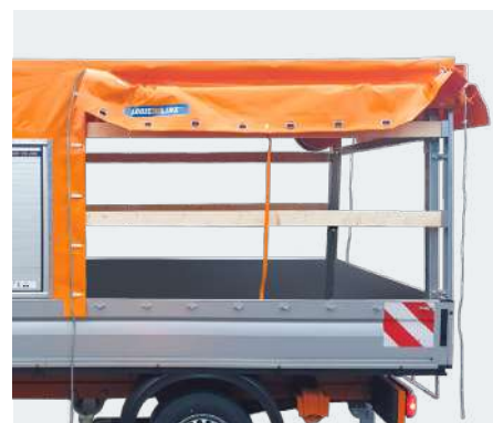
seitlicher und / oder heckseitiger Planenlift* zum schnellen und unkomplizierten Öffnen und Zugreifen
