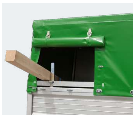
heckseitige Ladeluke* für schrägen Langguttransport; inklusive abnehmbarer Lastenauflage
