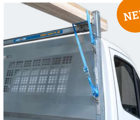
Vertikale Zurrseilen* am Beispiel FR-200 zur vertikal variablen Positionierung von Zurrpunkten
