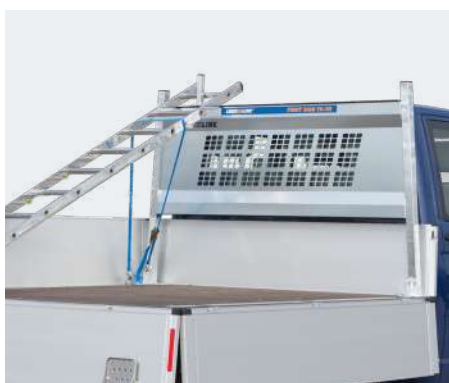
FR-100 speziell für VW Transporter; integrierter Heckscheibenschutz hemmt das Eindringen von Ladung in die Fahrerkabine
