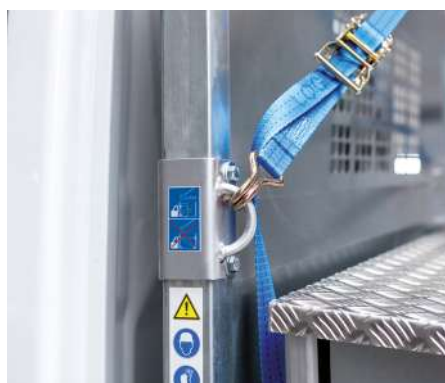
frei positionierbare Zurrkonsole* zur kraftschlüssigen Ladungssicherung
