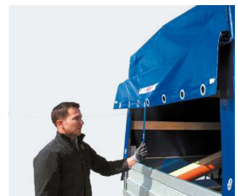
Planenlift (Federrollo)* heckseitig für schnellen Zugriff auf die Ladefläche
