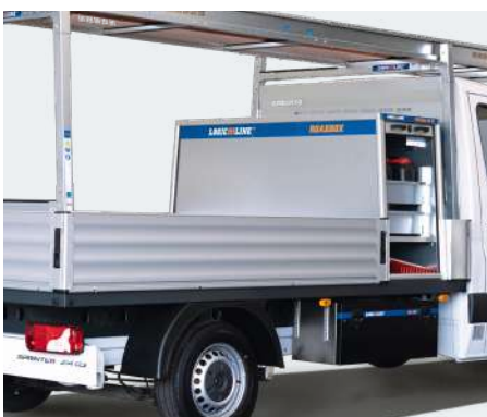
Integration* in gekürzte Pritschenbordwand
