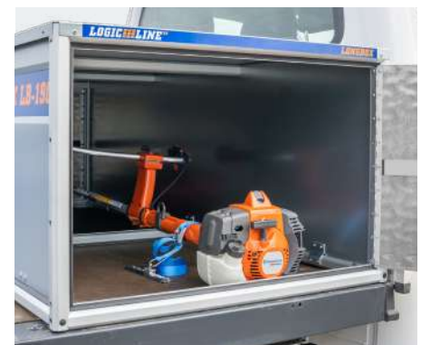
Querverstrebung in der Mitte schützt Ladung vor Verrutschen, schwere Einzelgüter ab 20 kg sind kraftschlüssig zu sichern, z.B. mit Zurrset für Gefahrgut*
