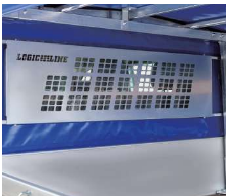
Heckscheibenschutz* hemmt das Eindringen von Ladung in die Fahrerkabine
