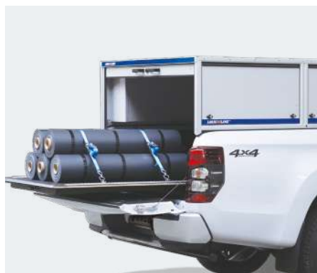
einfache Be- und Entladung von schweren Lasten bis 250 kg mit Schwerlastauszug* (S. 43)
