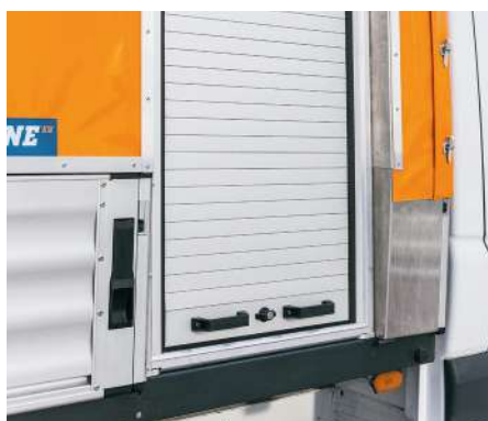
Integration* in gekürzte Pritschenbordwand und Plane; Planenfixierung oberhalb der Bordwand
