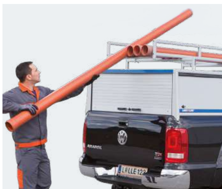
Langgutträger für PS-200* mit Laderolle zur einfachen Beladung von Langgut
