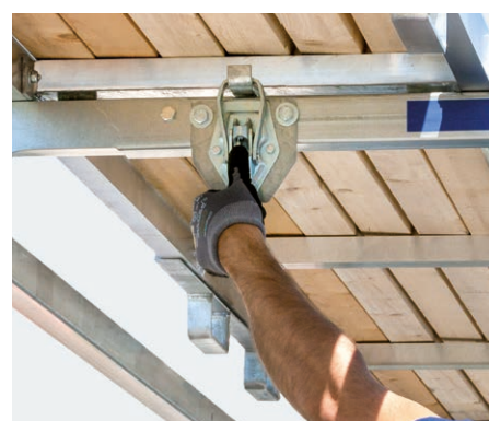
Schnellmontagesystem* für die rasche Befestigung des LongRacks auf dem PowerRack
