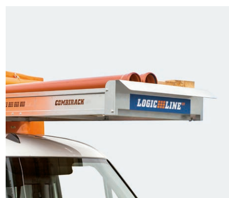
integriertes Formschlussblech vorne verhindert Rutschen der Ladung
