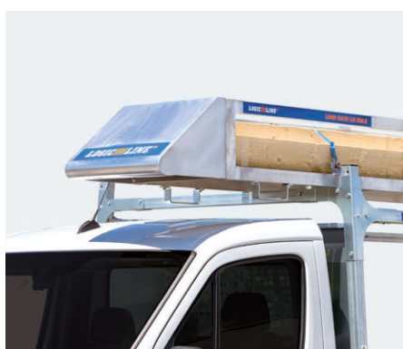
LongRack schützt Langgut durch Käfigbauweise; Formschlussblech mit Spoiler* ermöglicht effiziente Ladungssicherung
