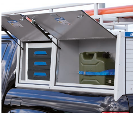
Ladencontainer* für Kleinmaterial; Seitenbox Hardtop* mit Zurrset*
