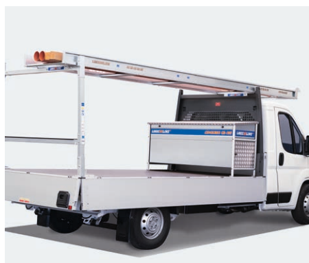
CombiRack kombiniert mit werkseitigem Fahrerhaus-schutz und CombiBox
