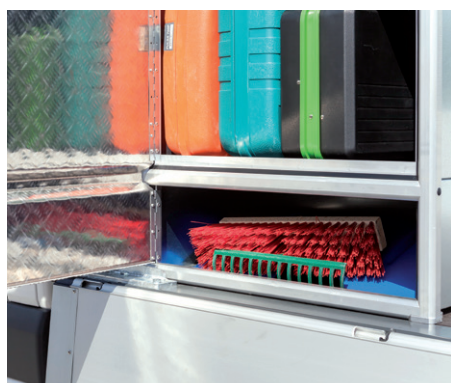
versperrender Stauraum* für langstieliges Werkzeug; Zugriff und Beladung von beiden Fahrzeugseiten
