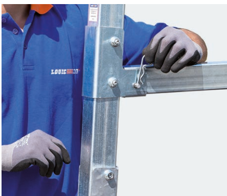
werkzeuglos abnehmbare Lastenauflage* zum schrägen Transport von Langgut am Heck des Fahrzeugs
