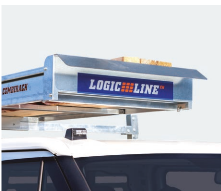
integriertes Formschlussblech vorne verhindert Rutschen der Ladung
