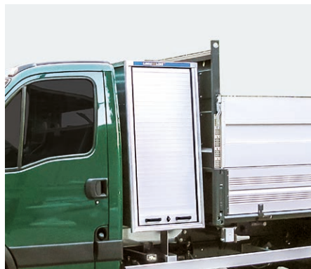
Montage mittels Konsole* auch zwischen Fahrer- kabine und Kipperaufbau möglich
