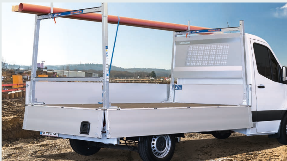
LogicLine FrontRack FR-200 mit Heckscheibenschutz und HeckRack-200 mit Lastenstopper
