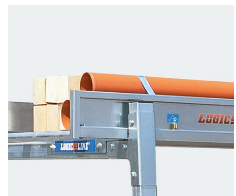
geprüfte Zurrpunkte im Langgutträger
